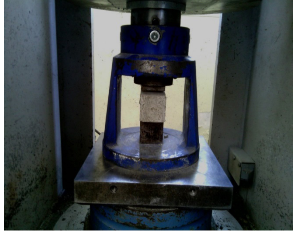
Basınç Deneyi Pres Cihazı
