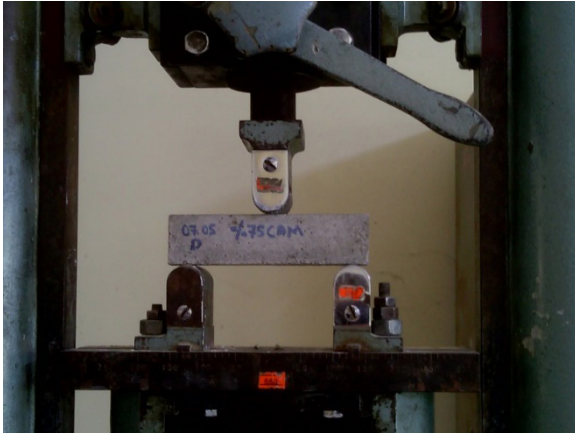
3 Noktalı Eğilme deneyi aleti
